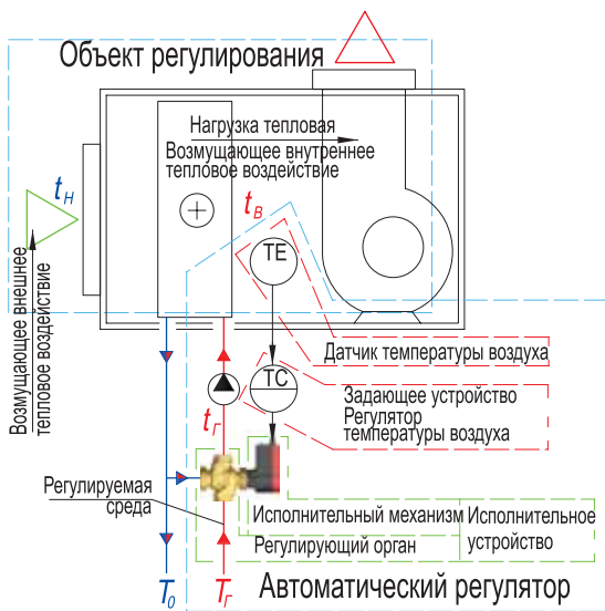
Рис. 1.6. Автоматическое регулирование температуры приточного воздуха вентиляционной системы
