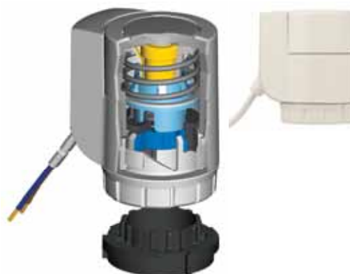
Рис. 2.7. Термопривод арт. 7711 NC - нормально закрыт, то есть, в обесточенном состоянии клапан закрыт; NO - нормально открыт, то есть, в обесточенном состоянии клапан открыт.
